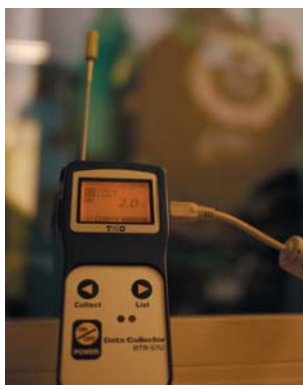
図2 鏡の温度をモニターした測定器具
