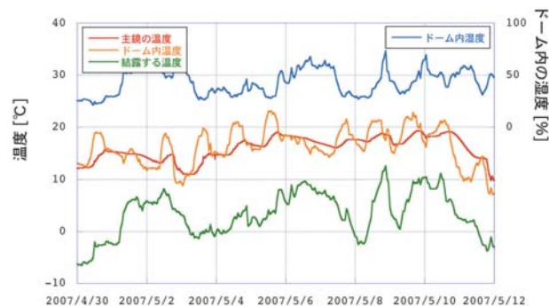
図3 2007年4月ころの鏡の温度、鏡の周囲の温度、結露する温度
