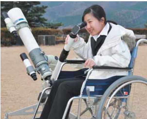
図3 車椅子に座った状態でも、無理のない姿勢で覗き口を自分の目の位置にもってこることができる。
