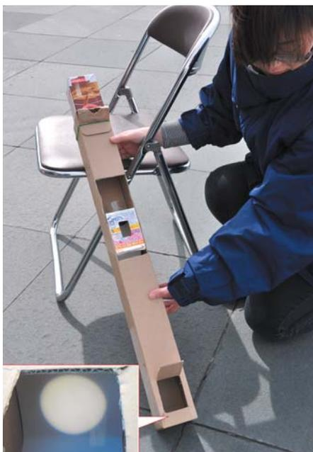
写真6 手作り太陽投影望遠鏡
