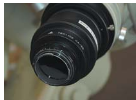
③接眼レンズをはすし、カメラマウントを取り付ける。
