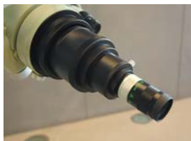
天体望遠鏡の接眼部（まだ接眼レンズが付いている）
