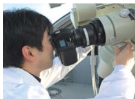
望遠鏡の調節ねじでピントを合わせる。
