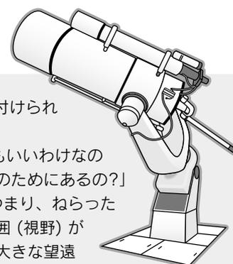
ぐんま天文台の65cm望遠鏡には、さらに2本の望遠鏡 (15cm望遠鏡と5cm望遠鏡) が取り付けられていて、合計3本の望遠鏡があります。
