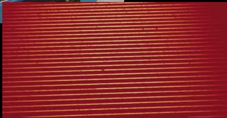
写真2: GAOESで取得したK型巨星 \alpha Boo (アークトゥルス) の波長600nm 付近のスペクトル画像
