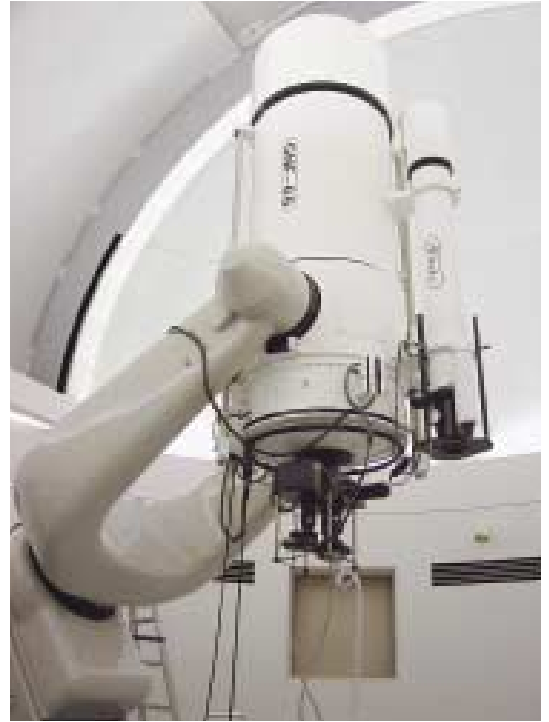
65cm望遠鏡に取り付けられた小型低分散分光器
